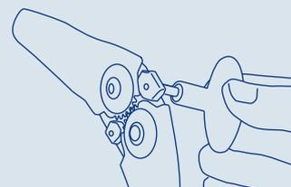
Piegare e flettere lo snodo un paio di volte e controllare che gli inserti siano posizionati correttamente.
